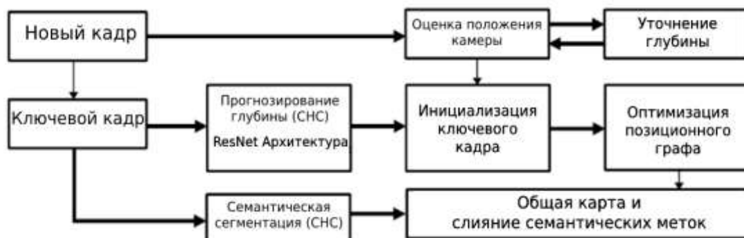
Схема. 2. Диаграмма применения СНС-SLAM алгоритма
