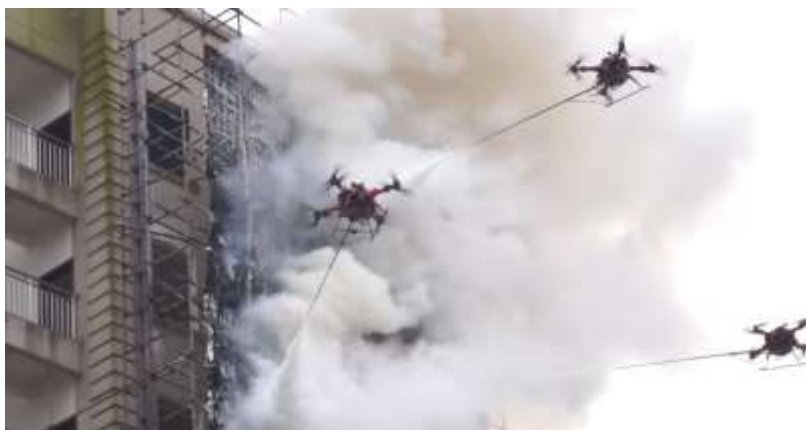
Рисунок 7 – испытание беспилотных летательных аппаратов при тушении пожара
